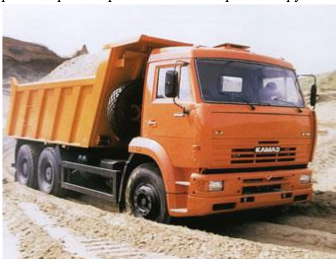
Рисунок 6.4 – Автосамосвал КамАЗ-6520-06 грузоподъемностью 20,0 тонн
