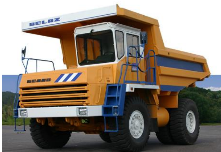
Рисунок 6.5 – Автосамосвал БелАЗ-75405 грузоподъемностью 30,0 тонн
