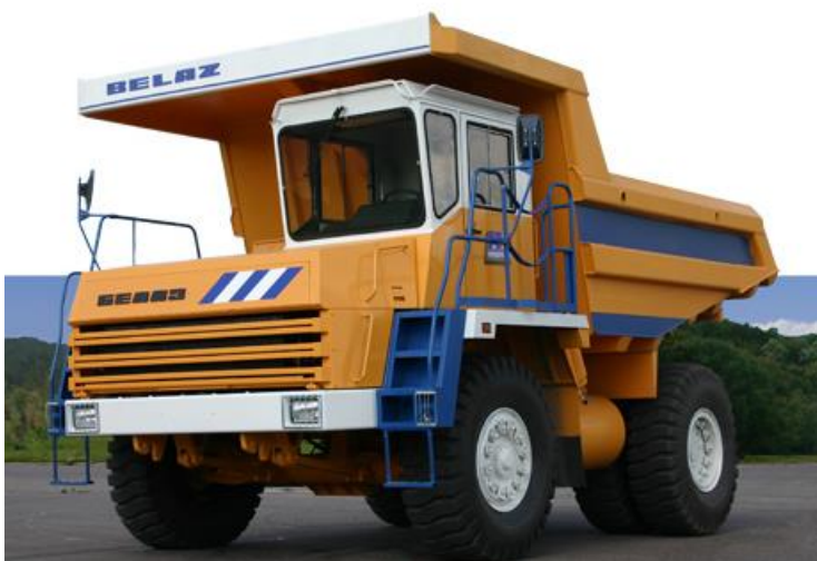
Рисунок 6.5 – Автосамосвал БелАЗ-75405 грузоподъемностью 30,0 тонн
