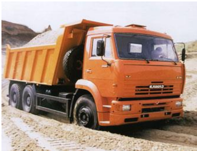
Рисунок 6.4 – Автосамосвал КамАЗ-6520-06 грузоподъемностью 20,0 тонн
