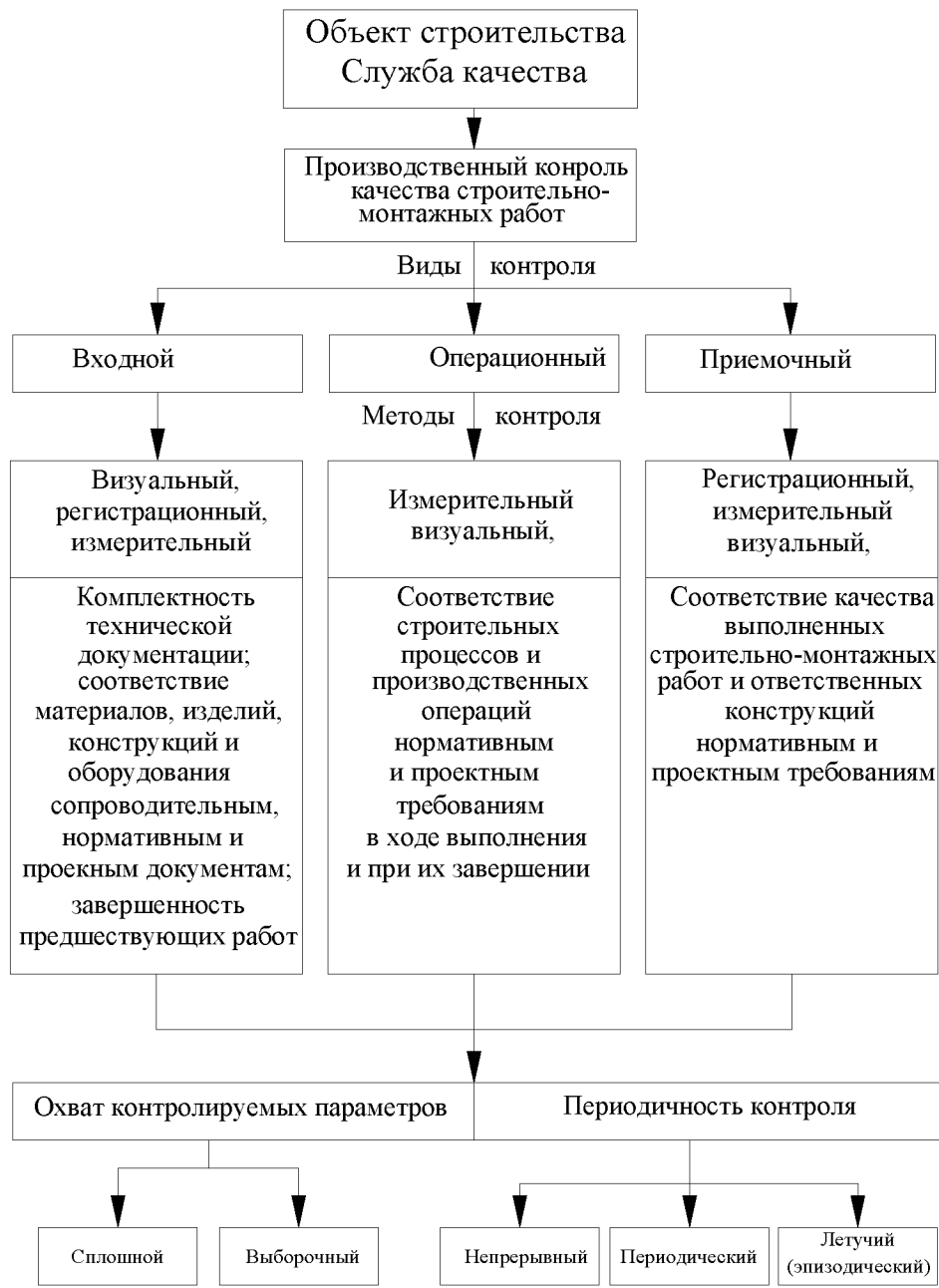
Рисунок 13.1 – Общая схема производственного контроля качества строительно-монтажных работ.
